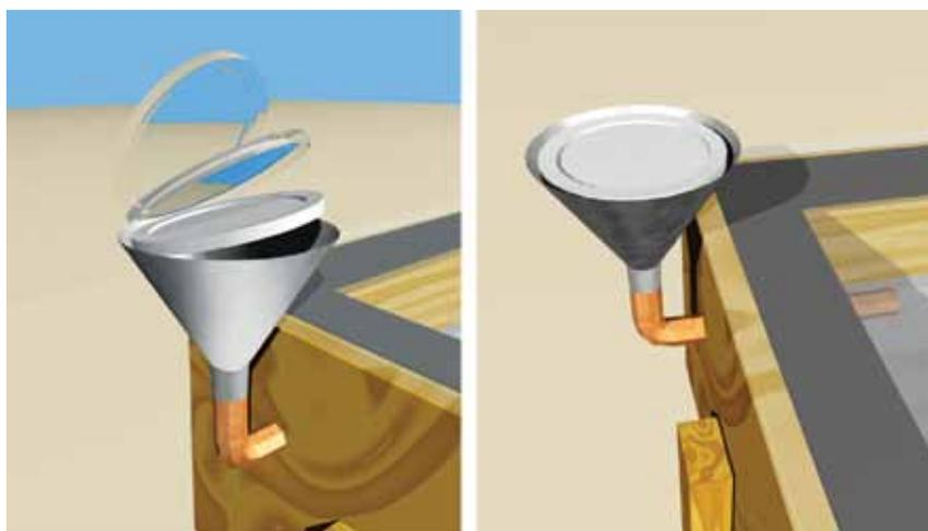
Figura 6. Embudo para verter el agua en el purificador solar de agua.
