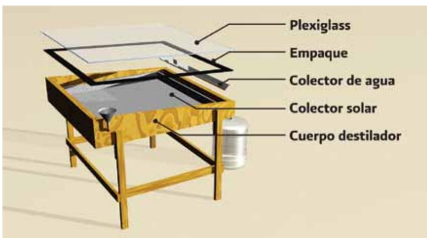
Figura 5. Vista del armado de la parte superior del purificador solar de agua.
