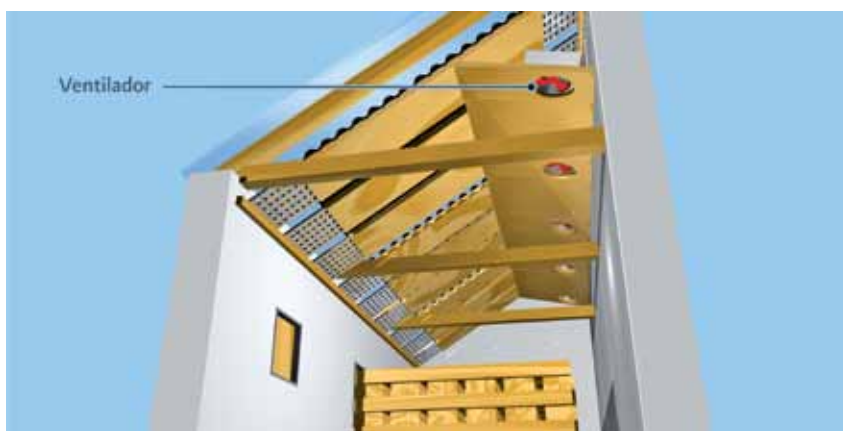
Figura 4. Vista interior del techo colector con ventiladores.
