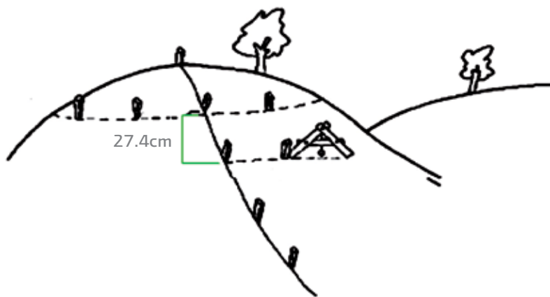
Figura 1. Distanciamiento entre curvas a nivel en predio con 45% de pendiente utilizando el factor de corrección.
