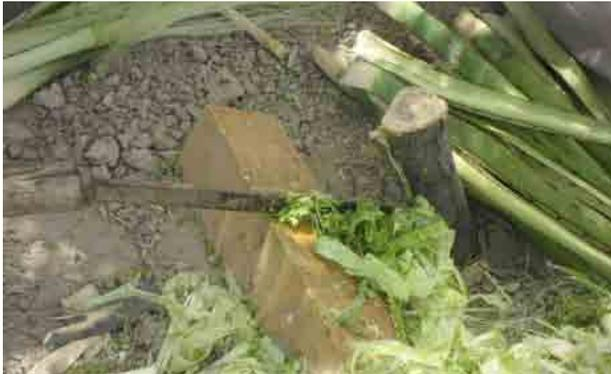
Figura 13. Utensilios rústicos empleados manualmente en el proceso de desfibrado de hojas de lechuguilla.
