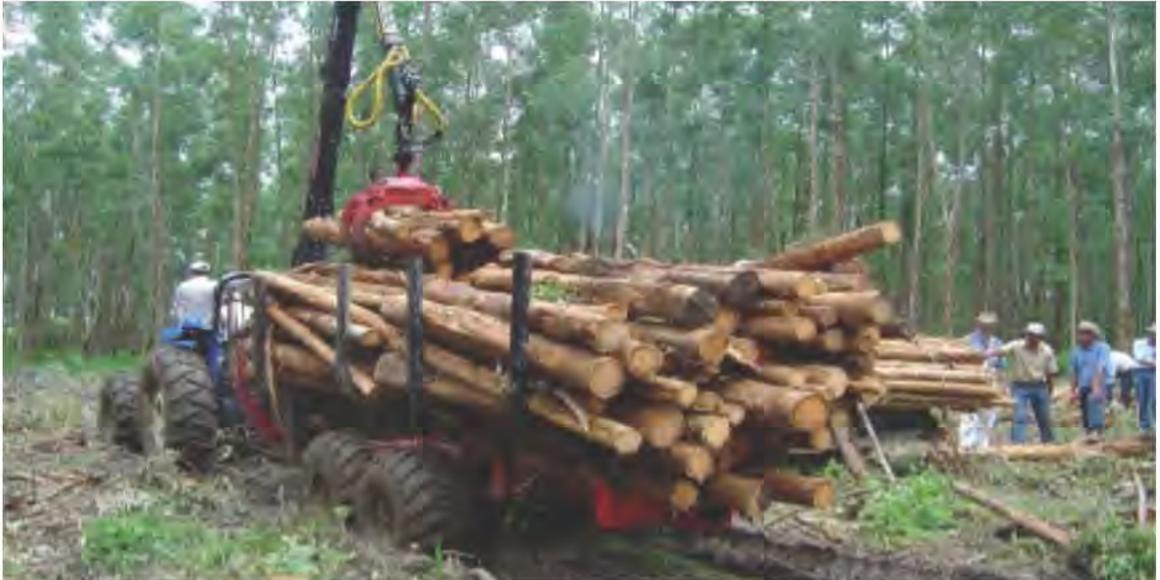
**Figura 139.** Arrime o extracción con remolque forestal equipado con grúa de auto carga y descarga, acoplado a un tractor agrícola trabajando en una plantación en el norte de Oaxaca. Dependiendo de la capacidad y tamaño del remolque, el volumen de carga por viaje varía entre 8 y 16 m<sup>3</sup> de madera en rollo.
