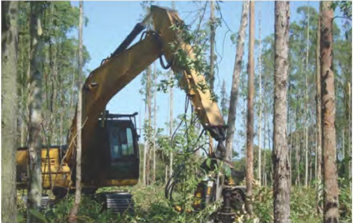
**Figura 130.** Procesadora forestal cosechando una plantación de eucalipto en Huimanguillo, Tabasco. Primera de este tipo en México, con rendimientos de hasta 120 m<sup>3</sup> de madera en rollo elaborada y descortezada por turno de trabajo.
