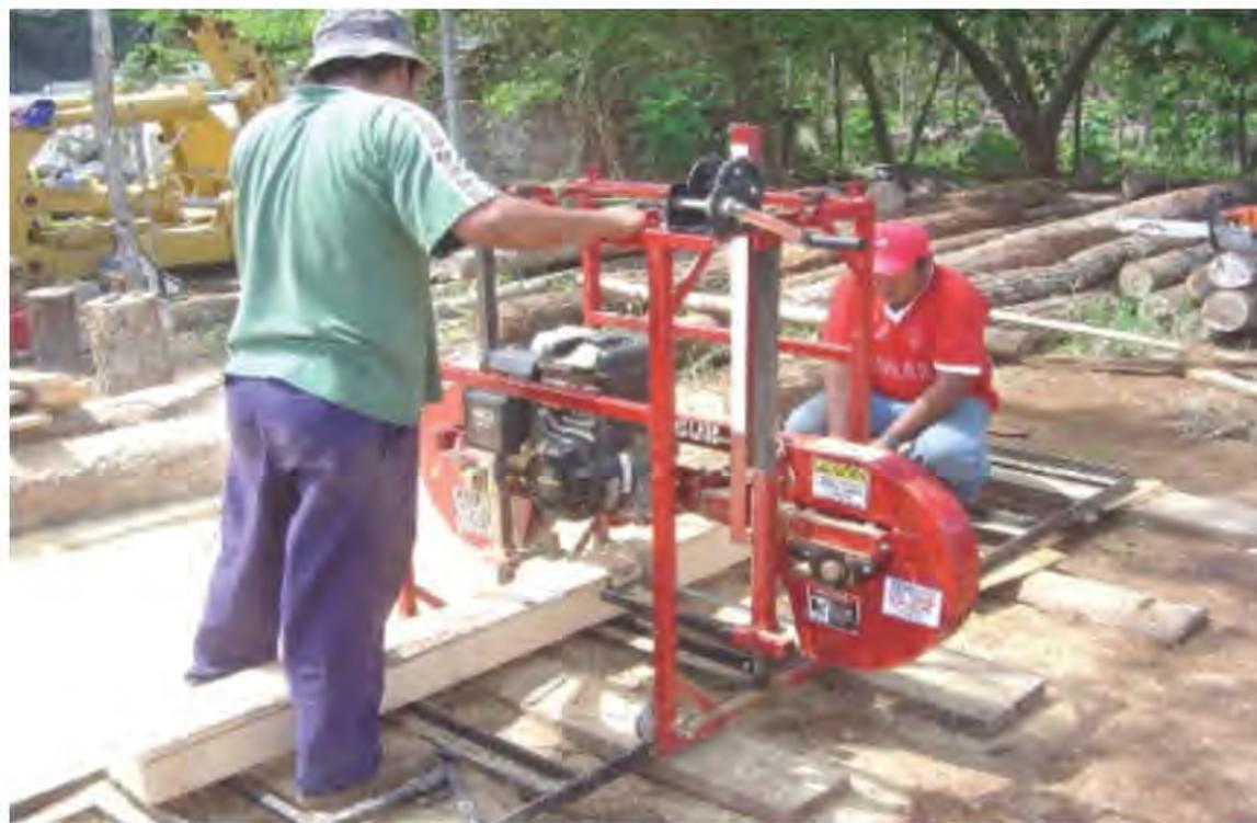
Figura 143. Aserradero portátil de empujón utilizado para aserrar madera de aclareos en las plantaciones de teca de la empresa AGSA en Campeche. Con árboles de 4 a 5 años de edad se obtienen polines para construcción.
