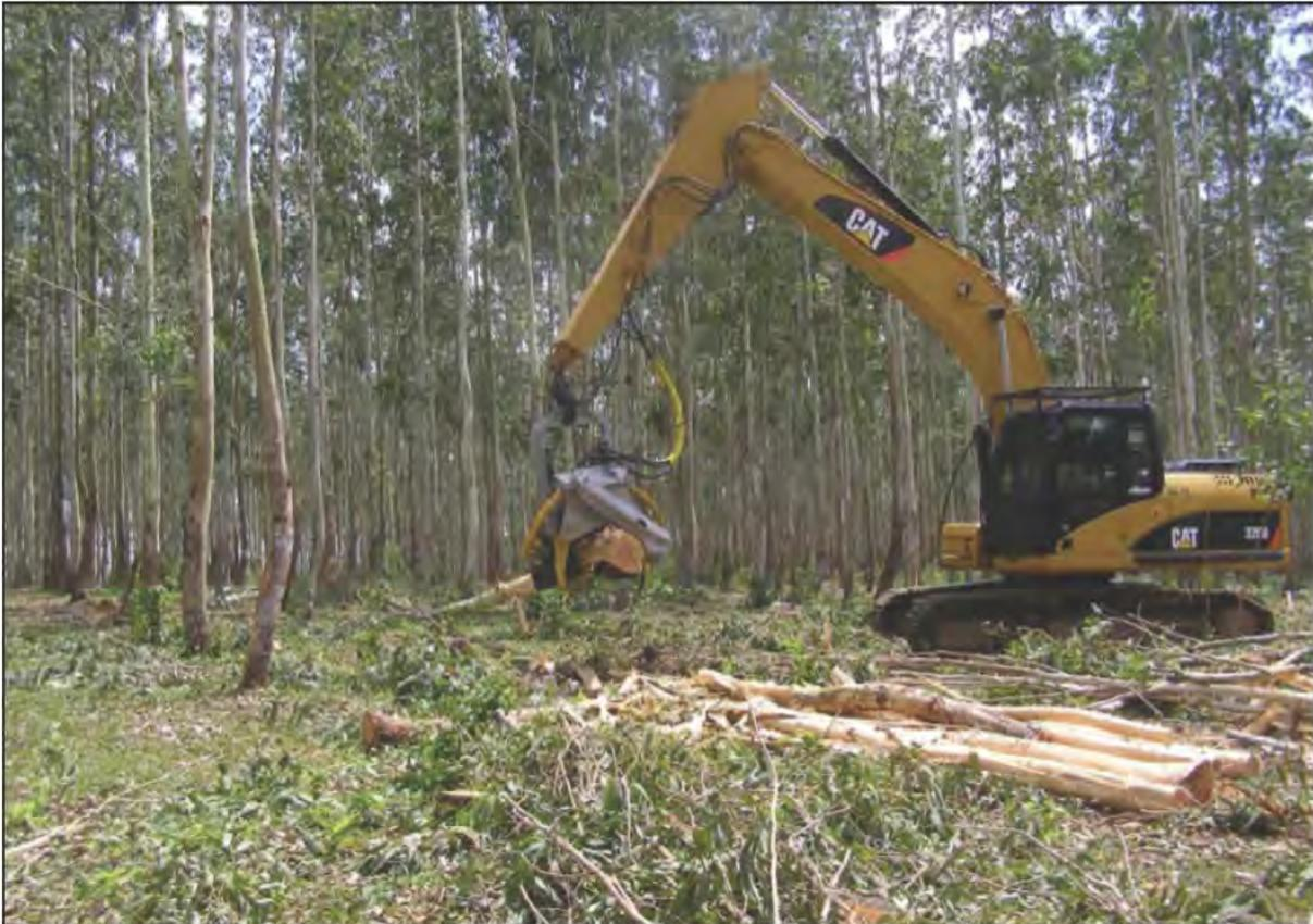
**Figura. 122. Harvester o cosechadora. Procesadora forestal trabajando en la cosecha mecanizada de plantaciones forestales comerciales en el Las Choapas, Veracruz. Primera máquina de su tipo en México; empezó a operar en agosto de 2008.**
