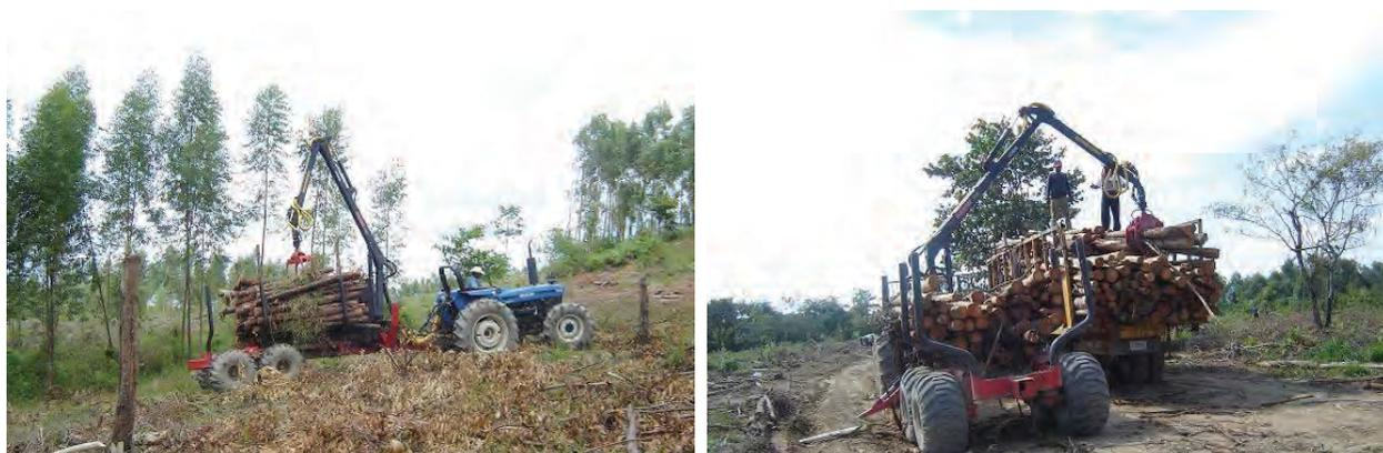
Figura 18. Cargadora acoplada a tractor agrícola.
