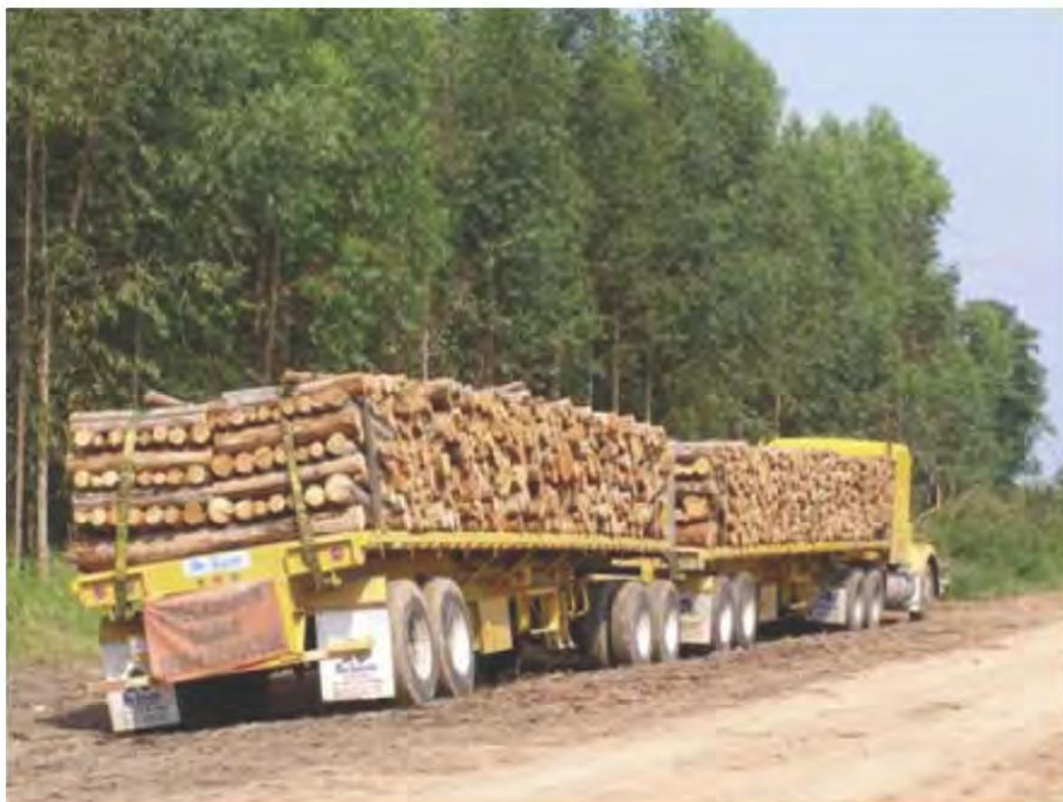
Figura 134. Tracto camión con doble remolque en Huimanguillo, Tabasco, cargado con 80 m<sup>3</sup> de madera en rollo para una planta de celulosa ubicada en Morelia, Michoacán.
