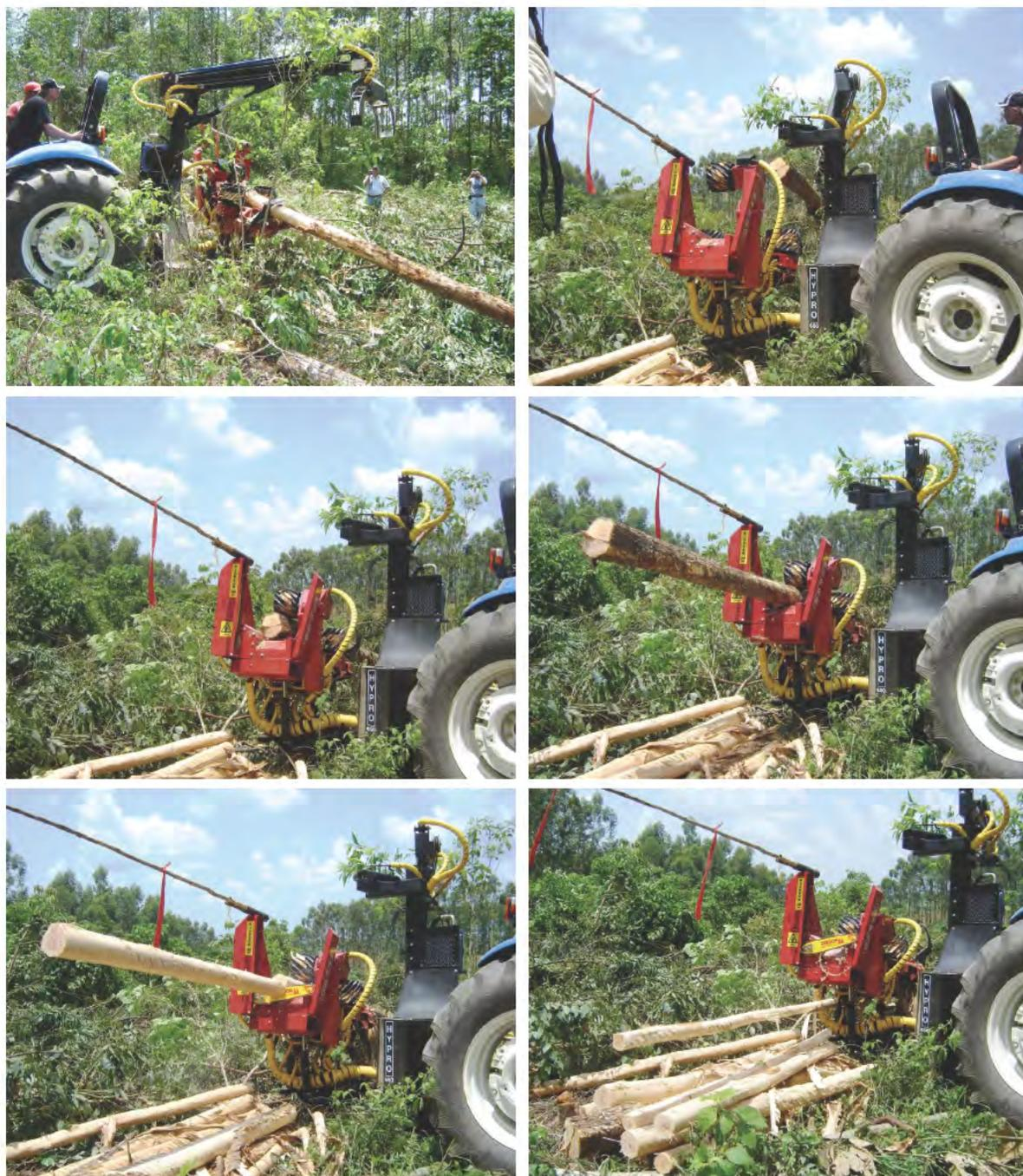
Figura 17. Desramado, descortezado y dimensionado de trozas con implemento Hypro.
