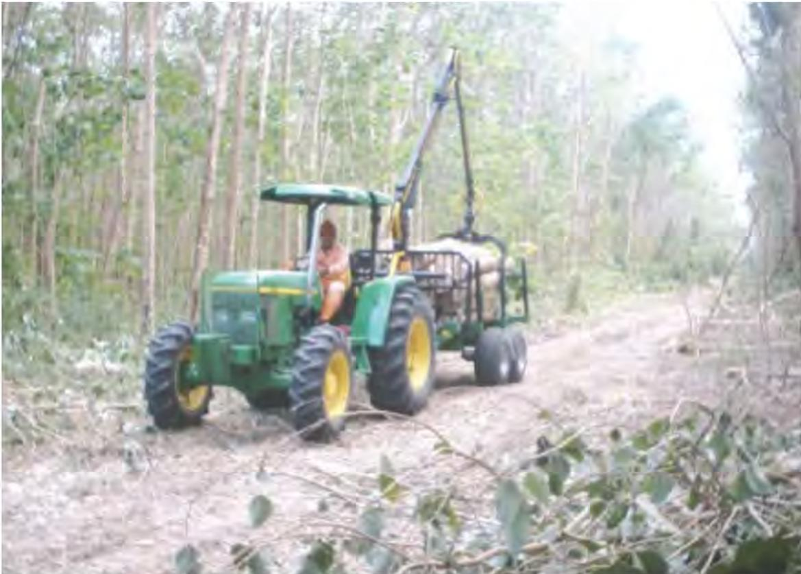
Figura 132. Carga y transporte en monte de melina en El Carmen, Campeche. Las trozas se trasladan a un patio, en donde son seleccionadas para separar el material celulósico del que se enviará al aserradero y fábrica de chapa de la empresa.
