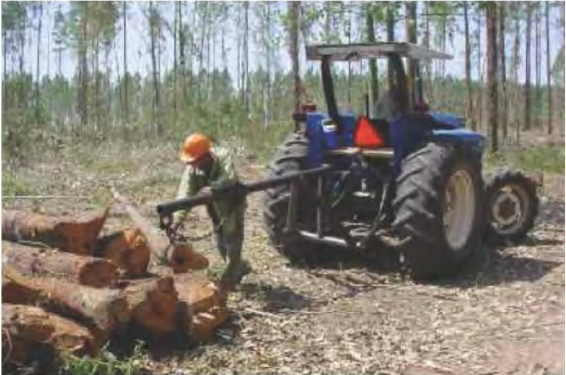
Figura 131. Tractor agrícola arrimando fustes completos de eucalipto en Balancán, Tabasco. El rendimiento promedio es de 60 m<sup>3</sup> de madera en rollo por turno de trabajo. El tractor agrícola es un elemento muy útil en terrenos planos u ondulados.
