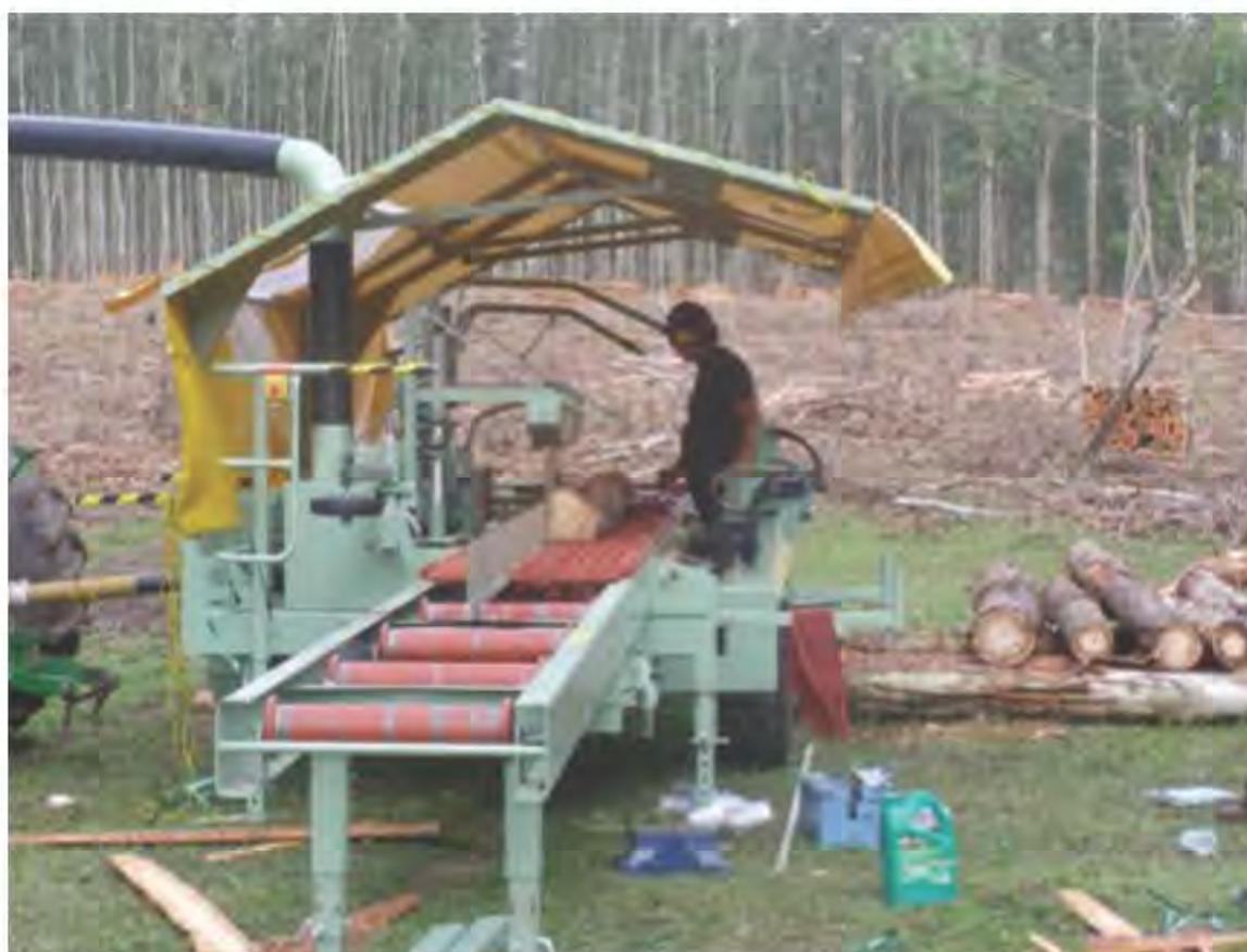
Figura 142. Aserradero portátil equipado con sierra circular, diseñado especialmente para el procesamiento de madera de eucalipto; trabaja acoplado a la toma de fuerza de un tractor agrícola que además sirve para trasladarlo de predio en predio.
