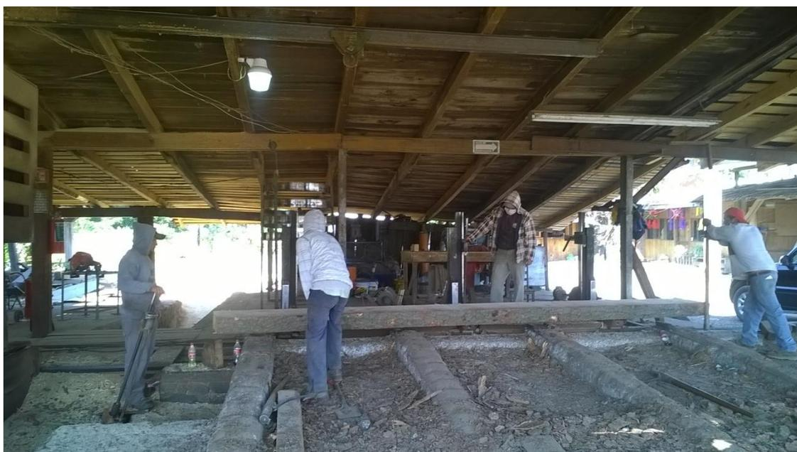
En las fotografías se puede observar la forma de producción de tablonés en esta industria de aserrío, la cual carece de tecnología moderna para la obtención de más productos. Falta de equipo en seguridad personal.
