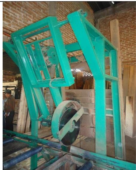
Imagen 20. Trocero péndulo con sierra de 16 pulgadas en Aserradero Cd. Hidalgo.
