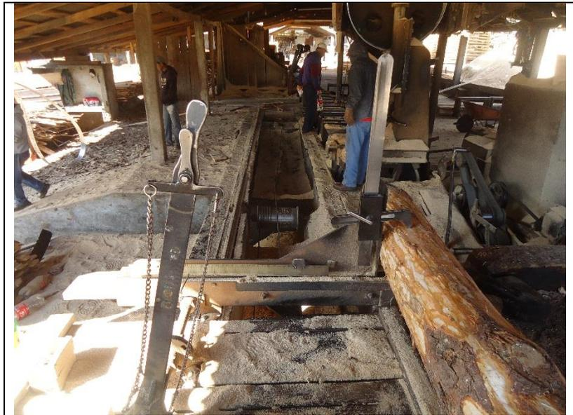
Imagen 8. Aserradero de la Región de Villa Madero, donde se muestra la Regla de medición en el piso del carro escuadra
