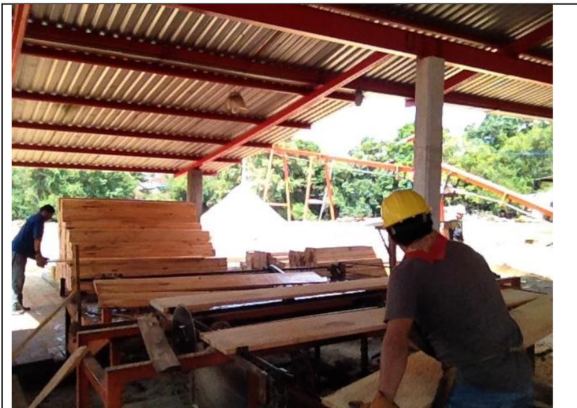
Imagen 21. Trimmer para dimensionado longitudinalmente la madera en escuadría, en la Región de Cd. Hidalgo.
