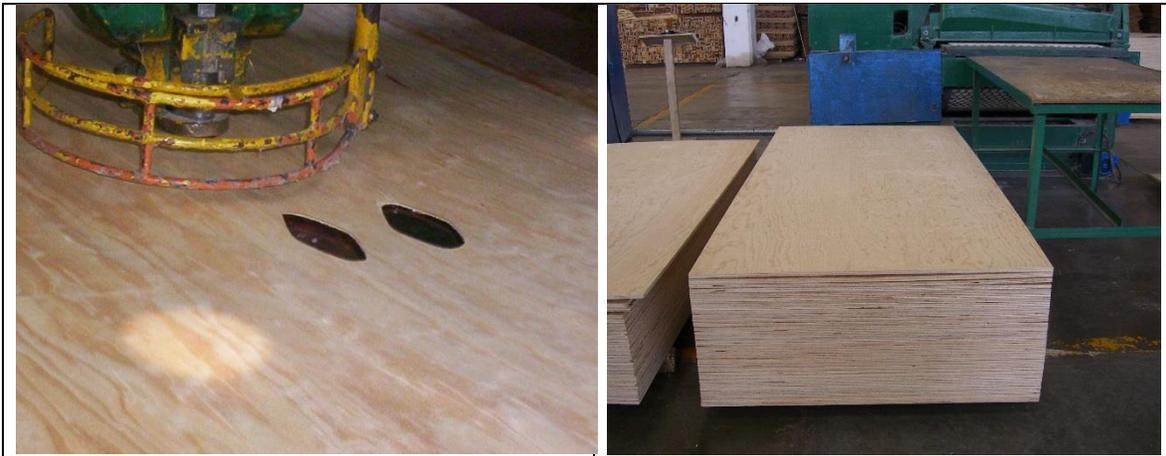
Imagen 35. Saneamiento y producto terminado (Tablero) en la Industria del Triplay y Tableros Contrachapados en el Municipio de Indaparapeo
