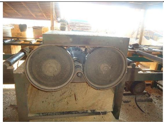
Imagen 18. Desorilladora con sierras de 14 pulgadas, el sistema de bandas planas utilizado y tamaño de poleas, en la región de Acuitzio del Canje.
