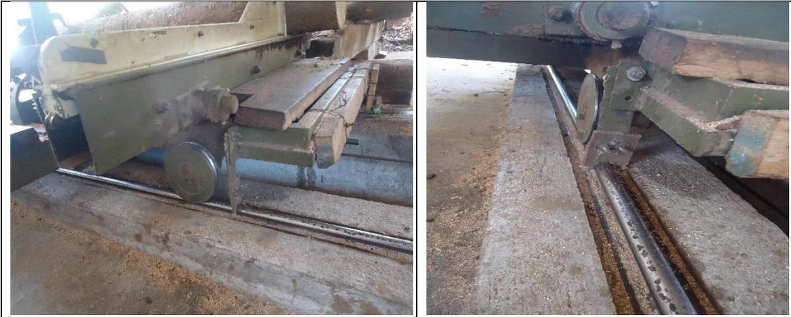
Imagen 9. Residuos de resina en las orillas de la guía, evidencia de que el carro únicamente se soporta en la parte alta de la guía circular.
