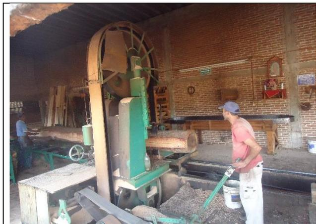
Imagen 7. Aserradero de la Región de Cd. Hidalgo, donde se realiza el primer corte hasta 6 pulgadas.
