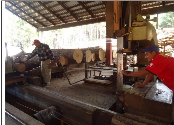
Imagen 10. El recorrido en vacío del carro porta troza, sin realizar cortes, aumenta los tiempos muertos, lo que se refleja en la productividad de los aserraderos mal instalados.
