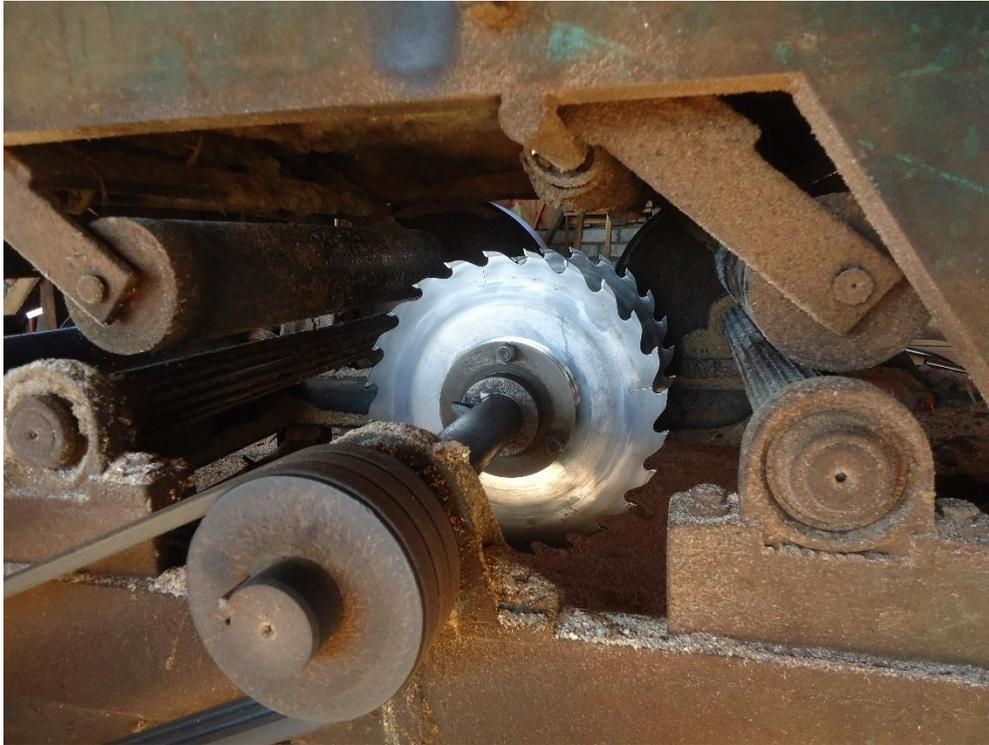
Sierras circulares de Ocho Pulgadas usadas en ocasiones en desorilladora en los aserrados de la Cuenca.
