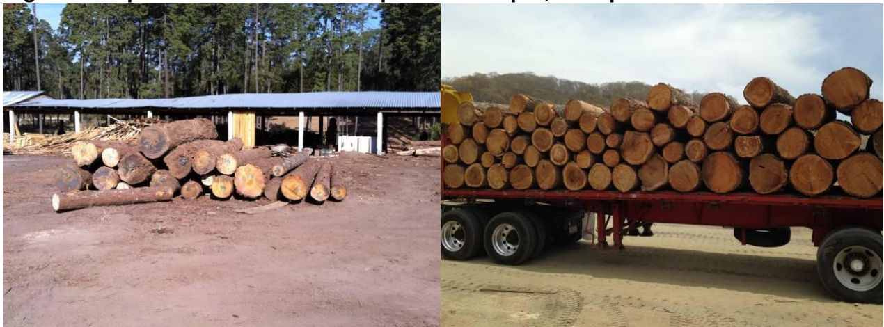
Figura 17. apilamiento de trozas en patio de acopio, múltiples diámetros
