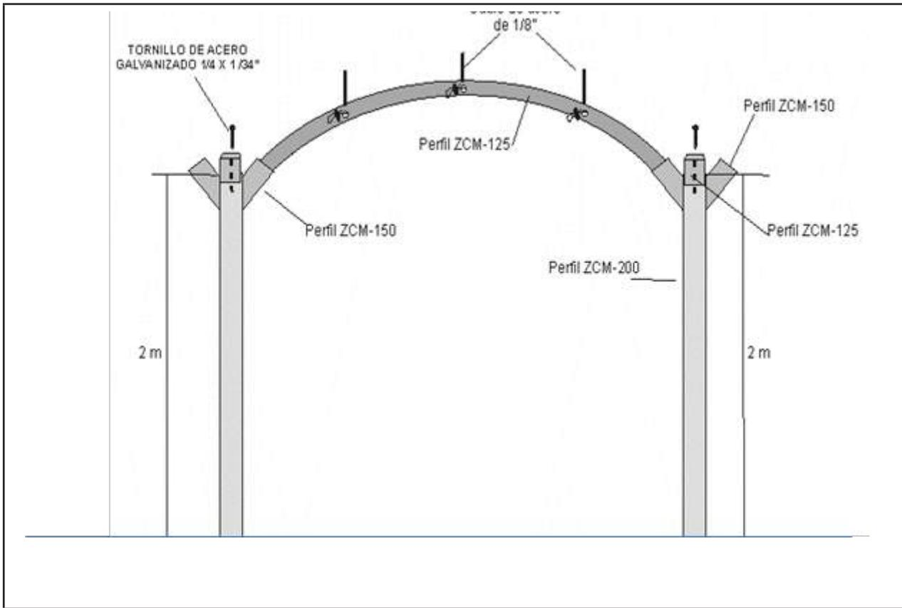
f) Diseño de estructura de soporte para malla sombra y ductos del sistema de riego
