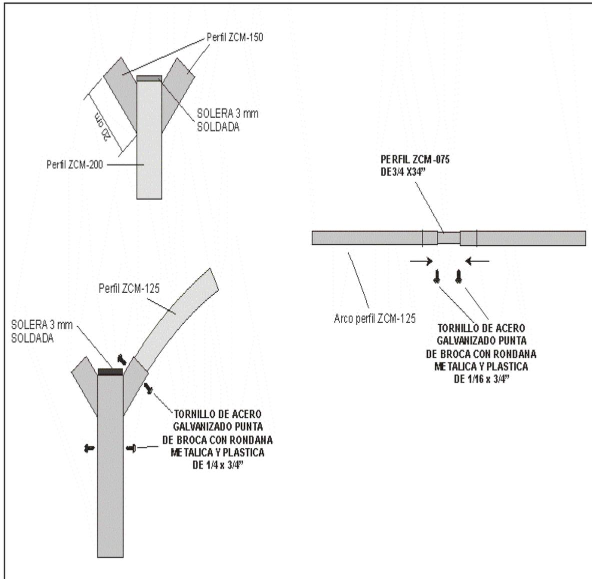
e) Diseño de un arco instalado.
