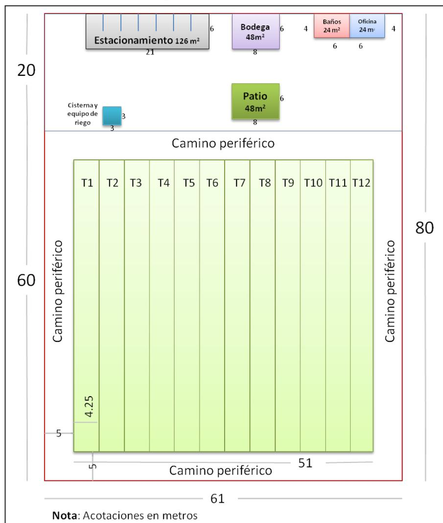
T1= Túnel 1 è 4.25 m | permite 2 hileras de mesas de 1.5 m (ancho) x 48 m (largo)
