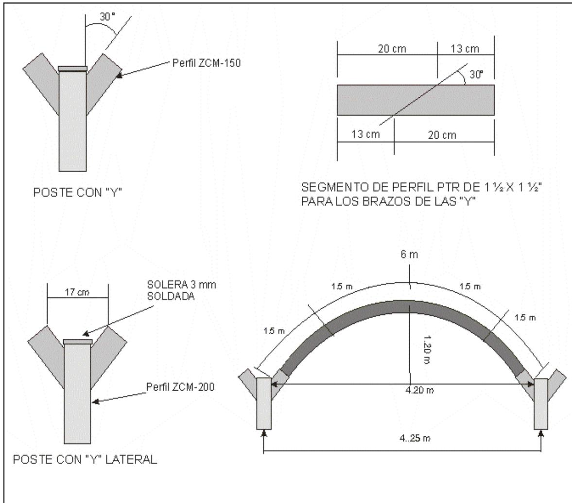
d) Diseño de uniones frontales y longitudinales de la estructura.
