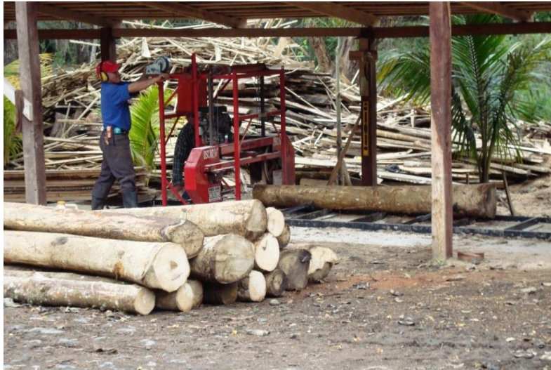
Fotografía 5.1.7. Aserrío de trozas de melina con el uso de un aserradero portátil.
