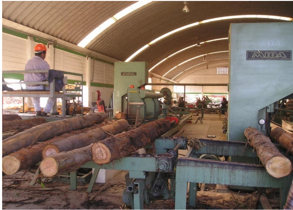
Fotografía 5.3.10. Líneas de producción de un aserradero en la empresa tres, procesando trozas de eucalipto.
