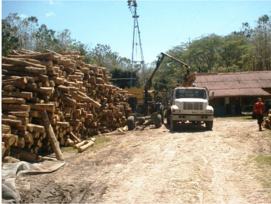
Fotografía 5.4.6. Carga de las trozas aserrables de melina en un camión rabón con la grúa con la que está equipado el remolque.
