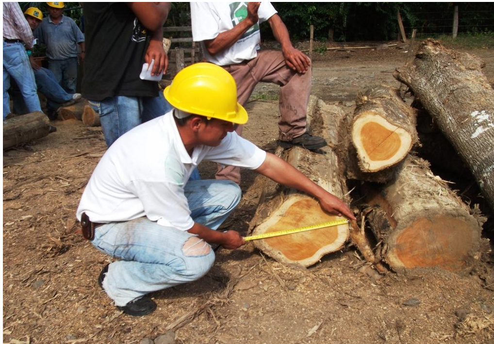
Fotografía 5.1.6. Cubicación de trozas de teca antes del proceso de aserrío.
