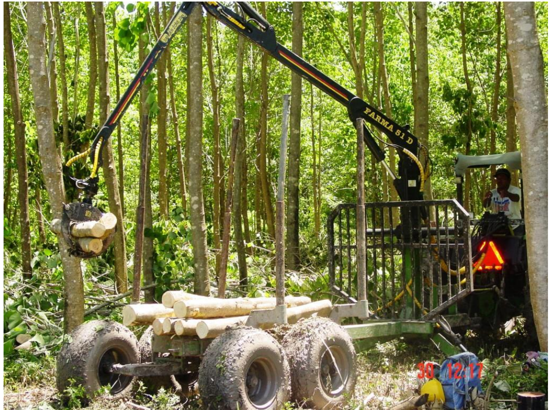
Fotografía 5.4.3. Remolque forestal acoplado a tractor agrícola trabajando en el arrime de trozas de melina en corta de raleo.
