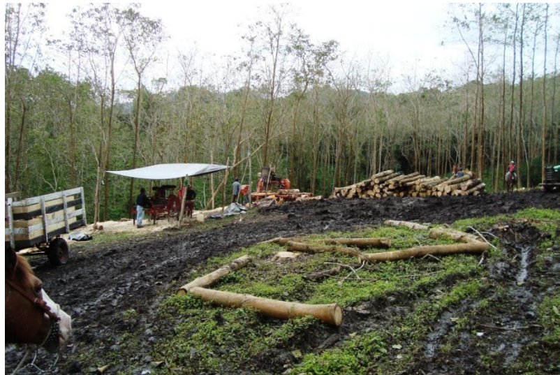
Fotografía 5.1.4. Aserradero portátil para la transformación de melina.
