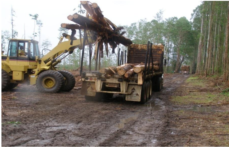
Fotografía 5.3.5. Carga de fustes completos de eucalipto con cargador frontal sobre ruedas.
