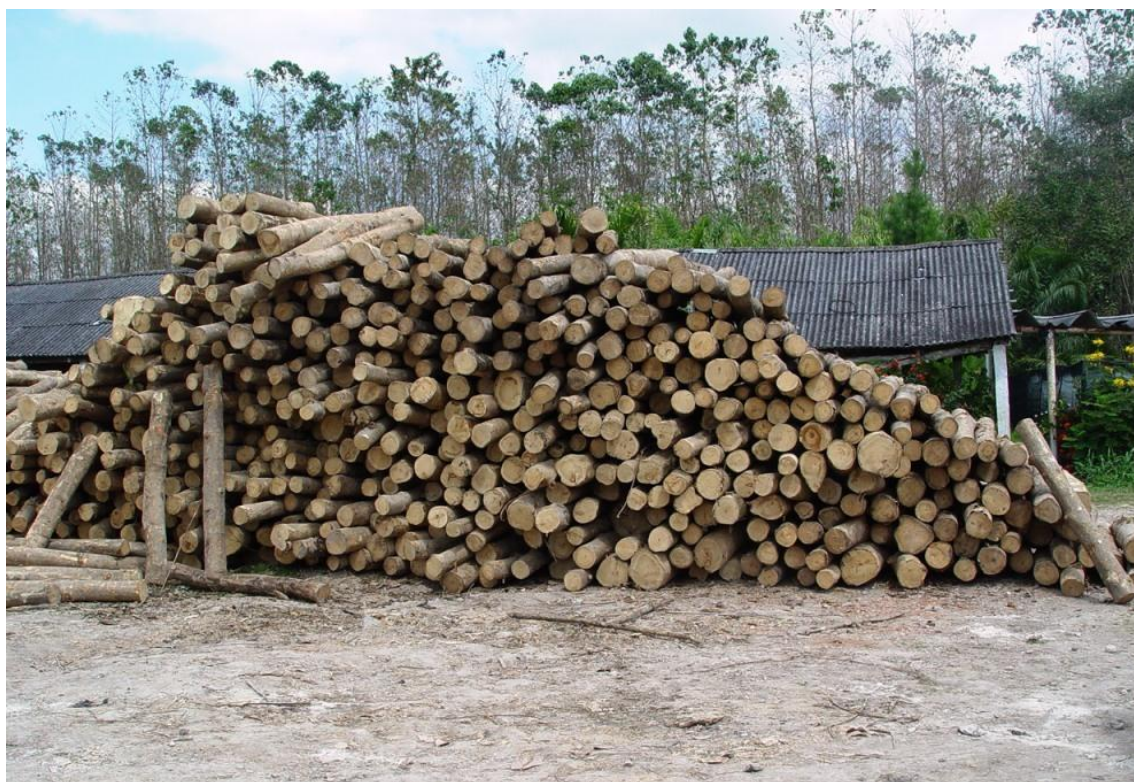
Fotografía 5.4.5. Trozas de melina para aserrío apiladas por separado en el patio de acopio.
