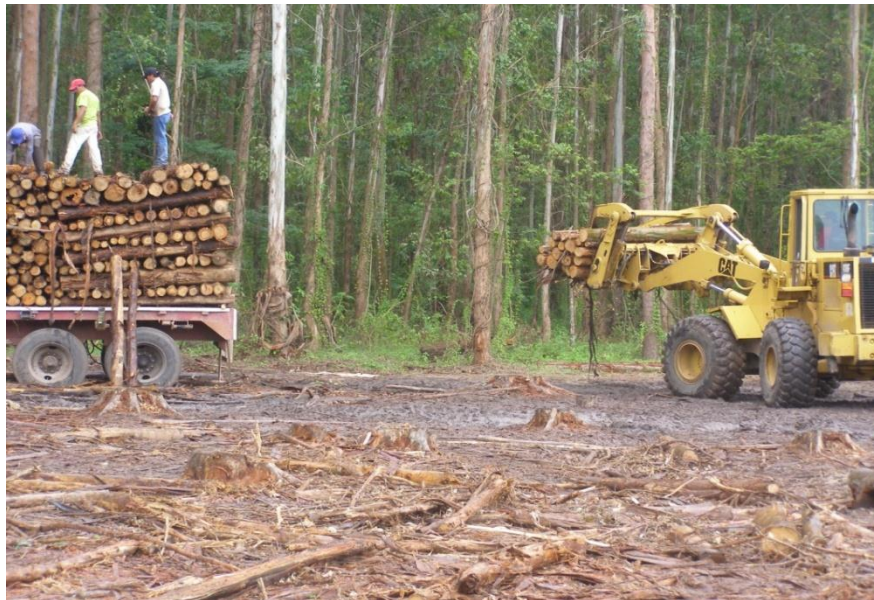
Fotografía 5.3.6. Carga de trozas de eucalipto para celulosa con cargador frontal sobre ruedas.
