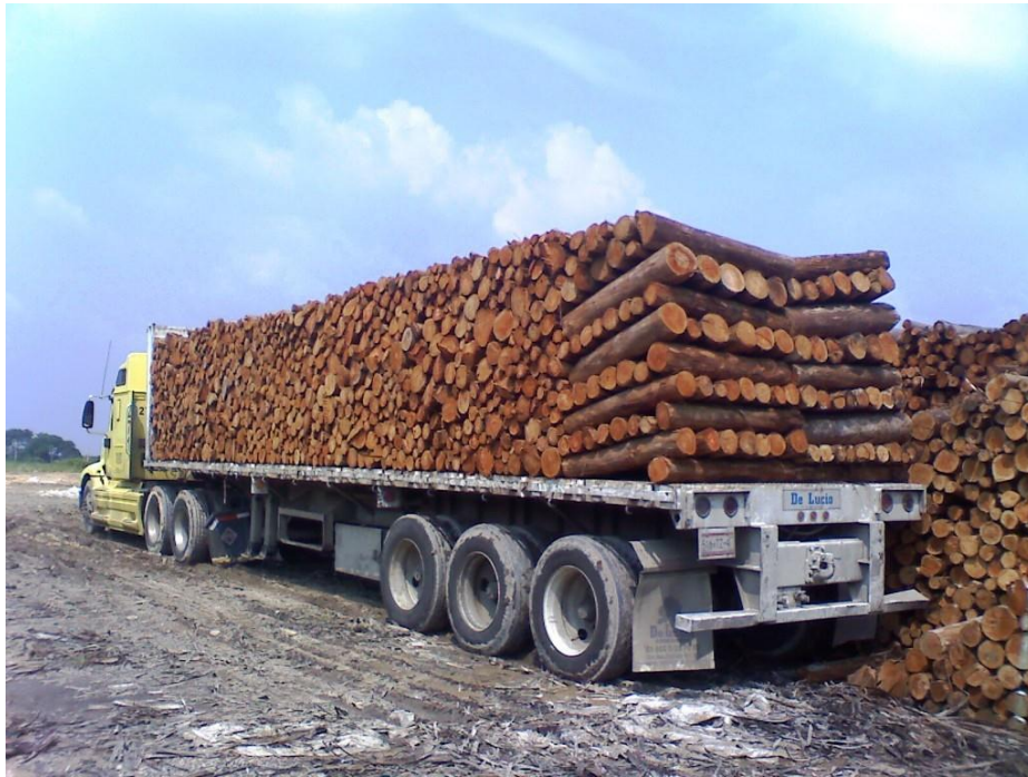
Fotografía 5.2.6. Tracto camión debidamente cargado para el transporte de madera en rollo de eucalipto
