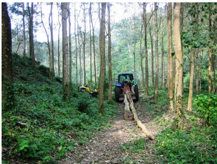
Fotografía 5.1.3. Arrime de fustes completos de melina con tractor agrícola.
