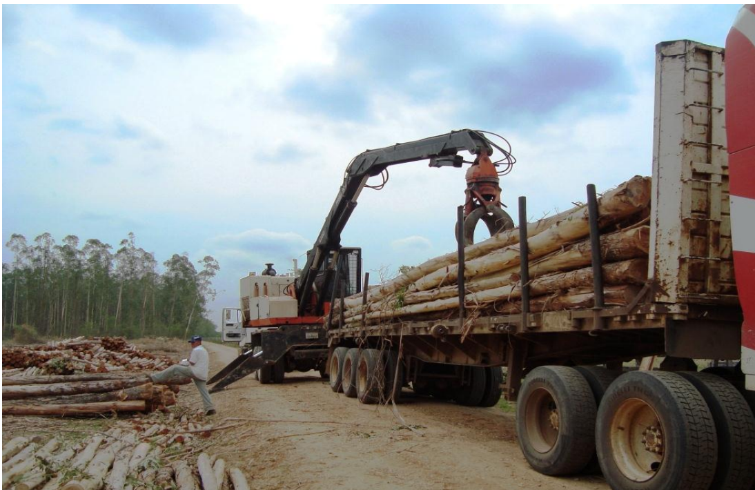
Fotografía 5.3.7. Carga de fustes completos de eucalipto con grúa tipo Bantam.
