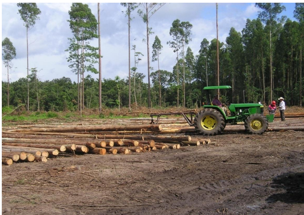
Fotografía 5.3.3. Fustes completos de eucalipto arrimados a la orilla del camino con tractor agrícola
