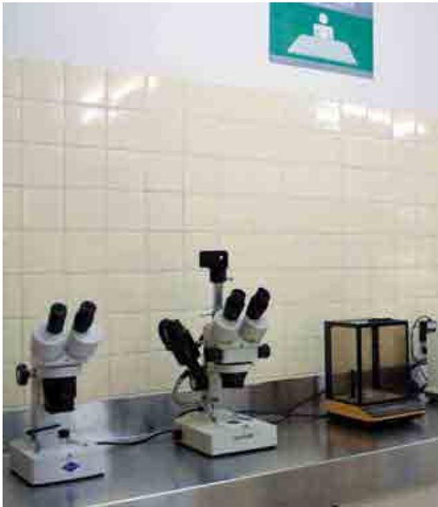
Equipo de laboratorio de un banco de germoplasma forestal: microscopios, balanzas y hornos de secado, entre otros.
