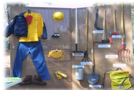
Fig. 32 Equipo necesario para combate de incendios
