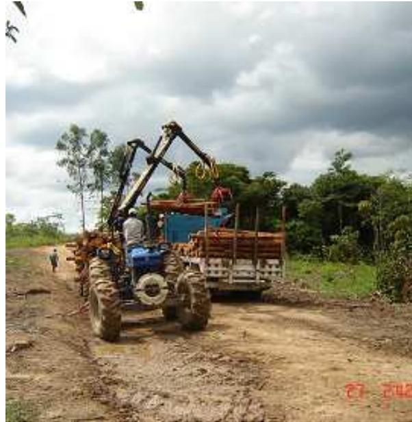
*Figura 3.84 Carga del camión con gruas Farmi.(2006)*
