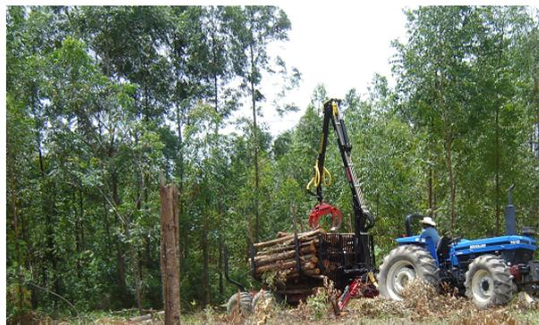
*Figura 3.83 Extracción y transporte con remolque (2005)*
