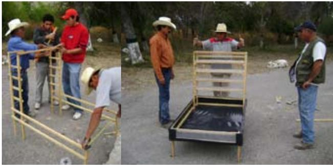
Finalmente, se forra toda la estructura con plástico transparente, para evitar la salida del aire caliente y el ingreso de insectos o polvo.
